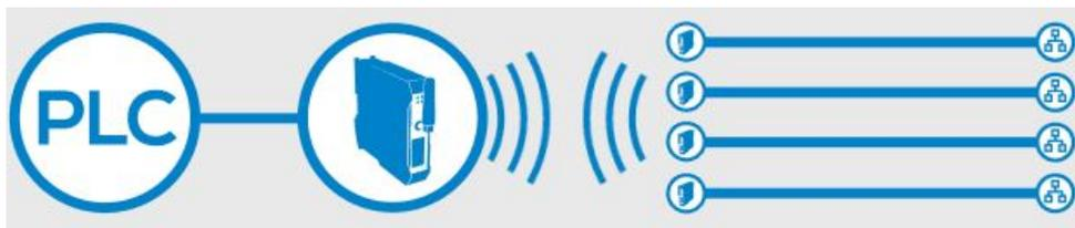
Über die im Master konfigurierbare Filterzeit können Funkstörungen unterdrückt werden. Erst nach Ablauf dieser Zeit erkennen die PROFIBUS Teilnehmer eine Busstörung. Alle Unterbrechungen der Kommunikation innerhalb der Filterzeit werden unterdrückt und die Anlagenverfügbarkeit wird dadurch erhöht.
